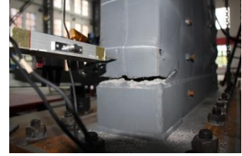
(c) Fracture propagation on the edge tube (d) Failure condition
