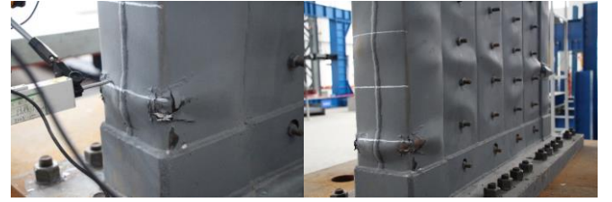
(c) Fracture propagation on the edge tube (d) Failure condition
